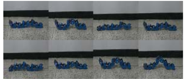
그림 14 GA 제어를 사용한 실제 로봇의 움직임. Fig. 14. Locomotion of Real Robot using GA controller.
